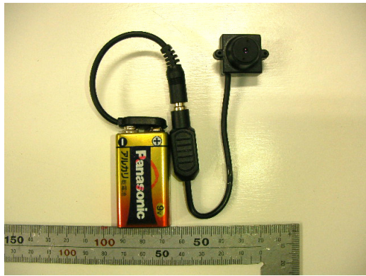
写真-1 超小型ワイヤレスカメラ
