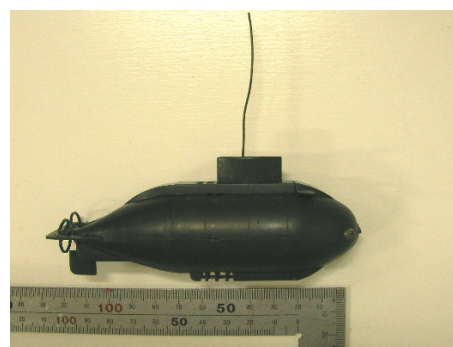
写真-3 実験に用いた潜水艦模型
