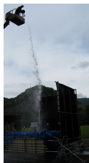
図-10 現地試験における落下水脈の状態
