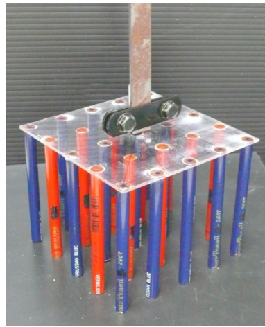
図-4 円柱群と固定アクリル板および鋼板
