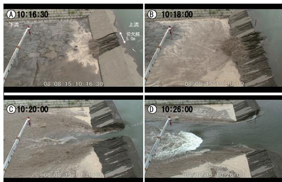
図-6 越流入量・破堤の進行状況
