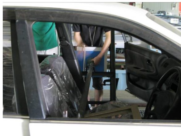
写真-2 ドアの押し開け力の計測状況
