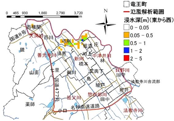
図-9 雨域が東から西へ移動する場合の浸水深（8.4時間後：溢水途中）
