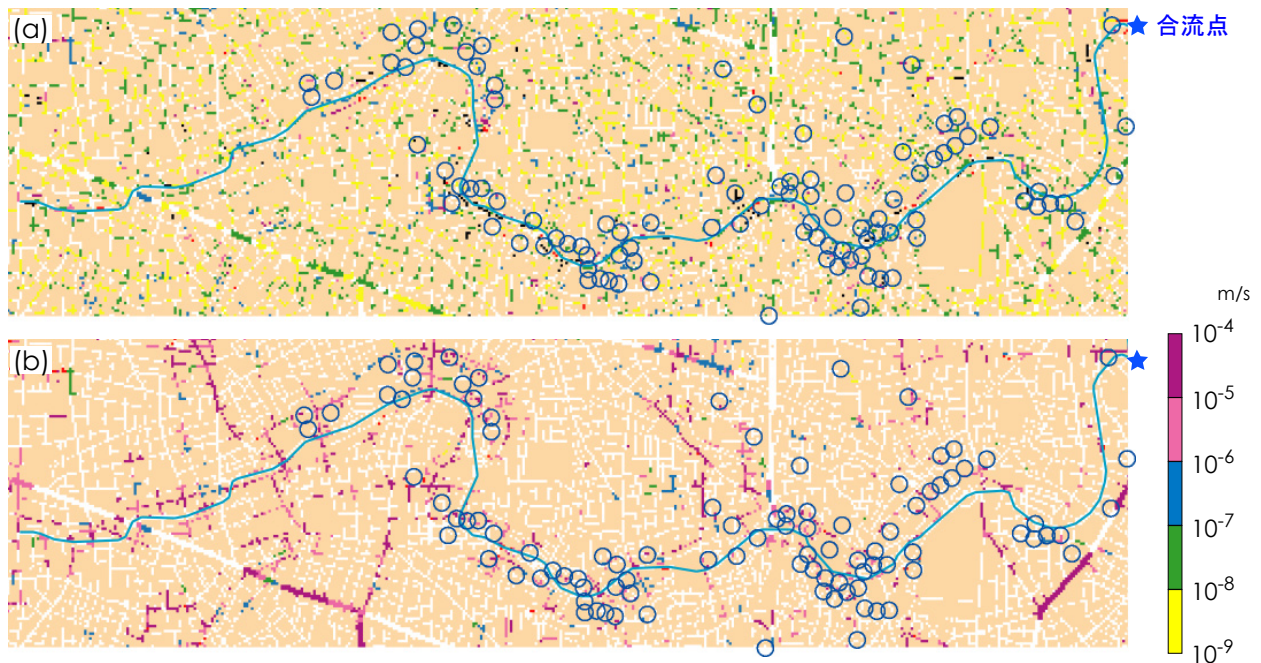
図-3 江古田川との合流点より上流側の妙正寺川流域に注目した浸水状況の拡大図（降雨開始から4時間後）：(a) 浸水深コンター図の拡大図（凡例は図-2参照），(b) 下水道からの逆流流量（地表単位面積当たりの逆流流量）の平面分布．図中の青色の○印は浸水実績地点（図-2 (d) 中の●印参照）．図の右上の★印の位置が合流点を表し，流れは左から右の方向である．
