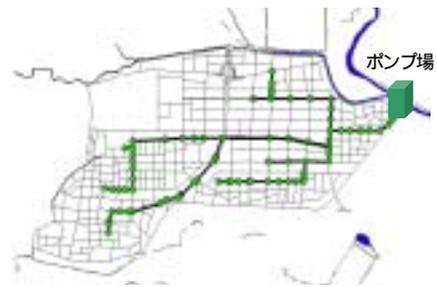
図-5 2000mm以上の下水管渠網
