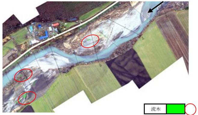
図-4 流木の堆積・捕捉 (渚滑川kp22.6~23.6km)
