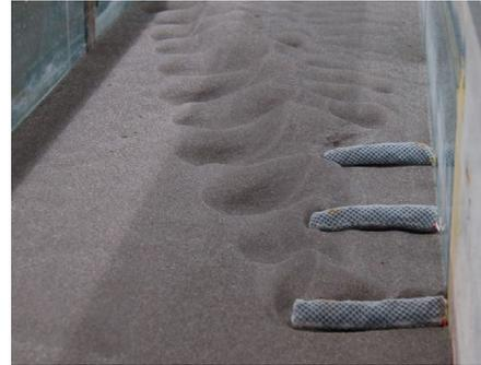
図-1 河床変動の様子 (ケース A)
