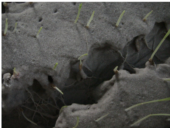
写真-4 植生による浸食抑制の様子 流路床は裸地斜面と同様に流路が形成されるが、側岸は安息角を越えて、地表面では流路幅が狭まっている。
