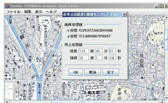
図-3 基準点の設置
