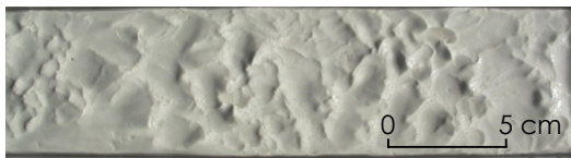
図-5 浸食を受けた供試体表面写真 上下端が側壁に相当する
