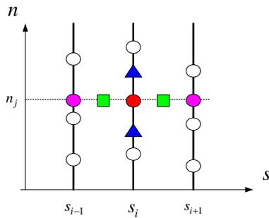
図-5 Soroban格子配置と変数の定義点
