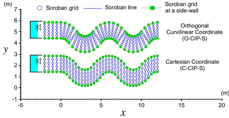
図-7 計算領域スケールと格子点配置に関する模式図(O-CIP-S法とC-CIP-S法の比較)
