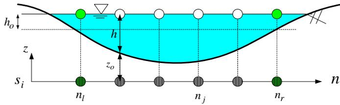
図-6 河道断面における格子点配置と水際の定義
