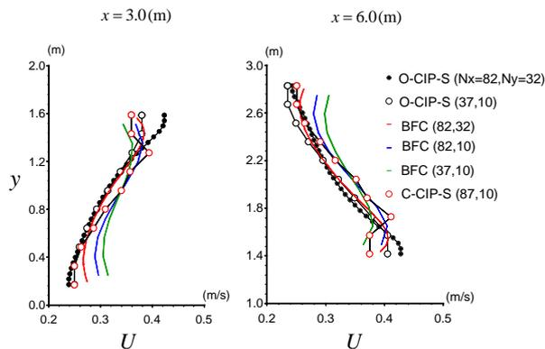
図-10 x方向の流速 $U$ に関する計算結果の比較
