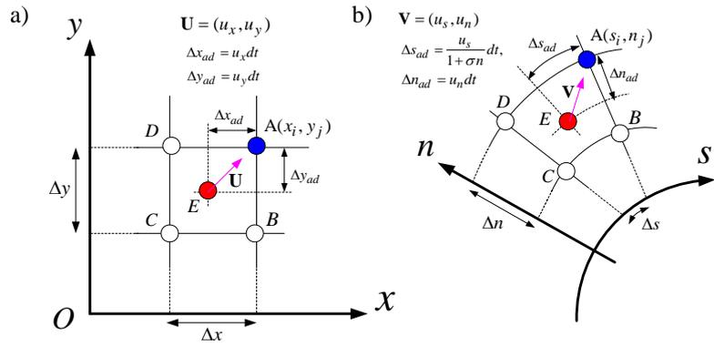
図-2 CIP法における移流プロセスの模式図
