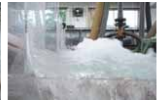
写真-1 越流水深及び減勢工ユニット幅の相違による流況の変化(不透壁、突起無し)
