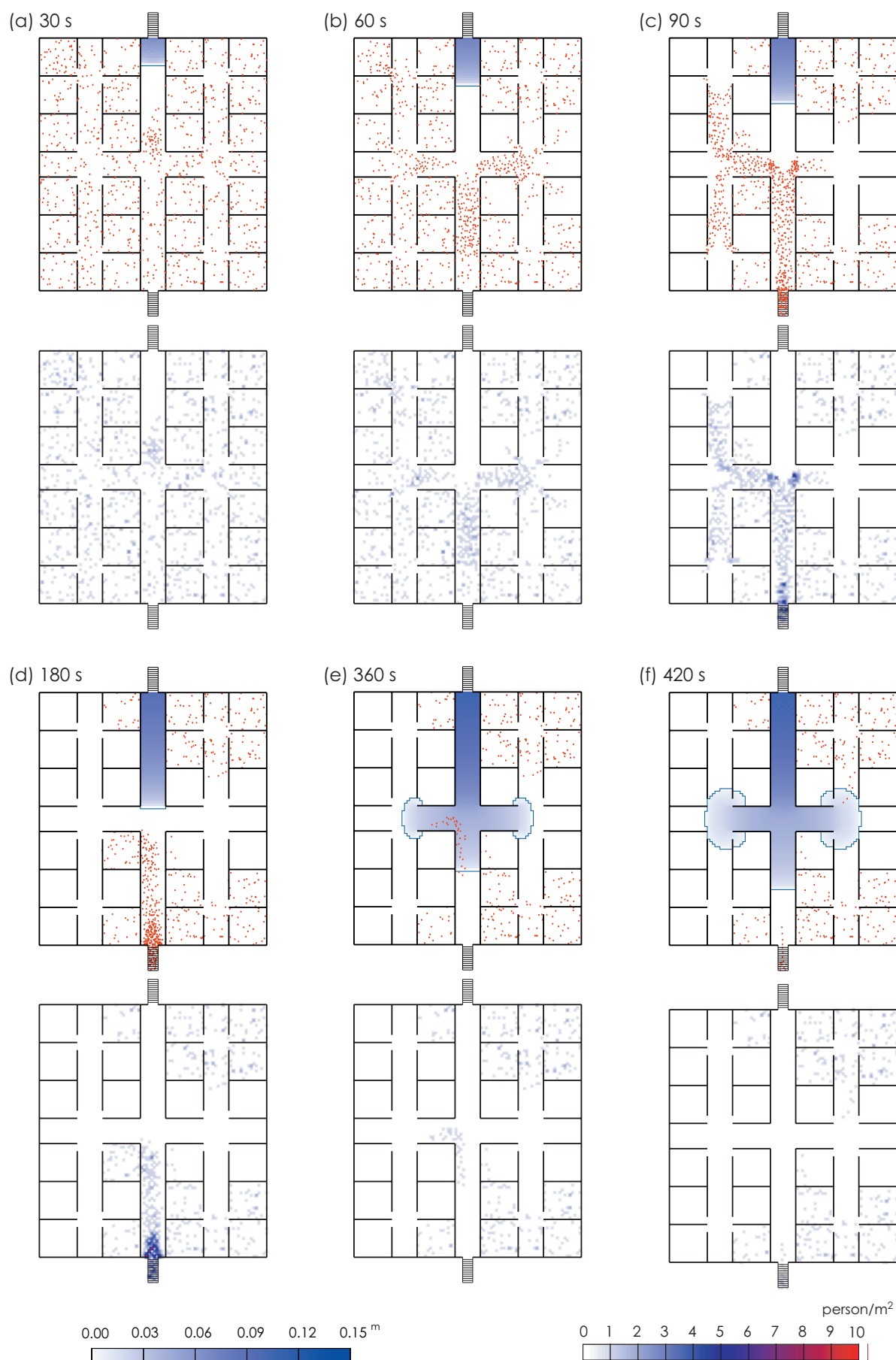
図-4 避難行動解析の結果：各々上段が避難者の位置（●）と水深のコンター図，下段が群集密度のコンター図 浸水開始後それぞれの時刻での結果を表す。凡例は左が浸水深，右が群集密度の値をそれぞれ表す。青の折線は浸水フロントを表す。
