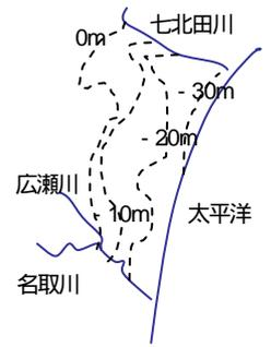
図-5 沖積砂礫層の標高図
