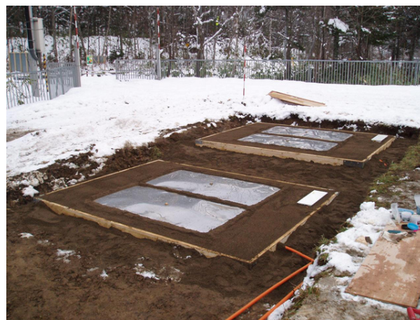
写真—1 積雪重量計設置写真
