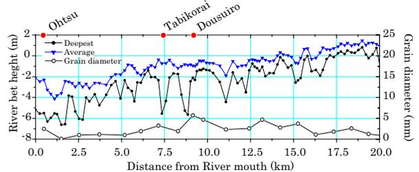
図-3 十勝川の縦断形状と平均粒径の縦断分布
