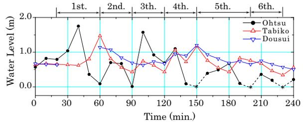
図-2 地震発生4時間後までの10分間隔水位記録(黒線で示した大津観測所の記録は0m以下の水位が欠測だったために\*で示したように補完している。)
