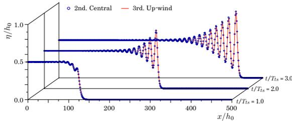
図-1 波数分散現象の数値解析における2次精度中央差分と3次精度風上差分の精度比較(3次精度風上差分は2次精度中央差分に比べ、後続波の位相がごく僅かに遅れるものの、波頭部に関しては両者は非常に良く一致する。)
