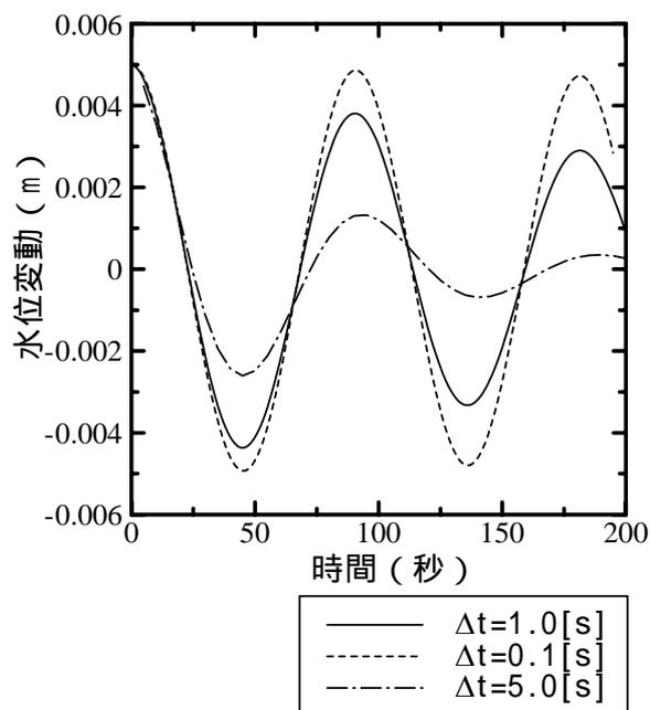
図-4 計算時間間隔  $\Delta t$  の大小によるセイシュ振幅の時間変動．水位の抽出地点は  $x=10\text{m}$  (側壁近傍) に対応．
