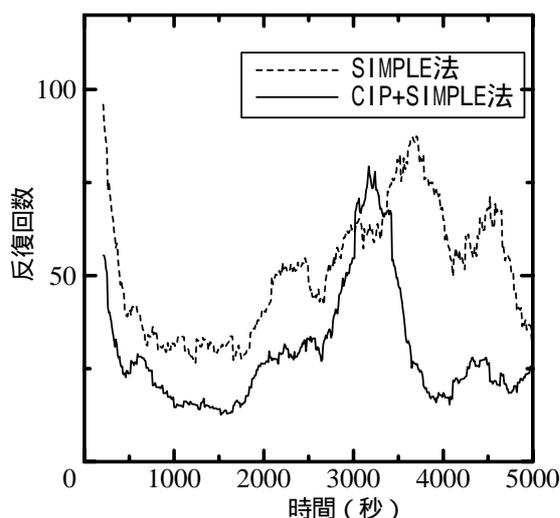
図-5 内部セイシュの計算における、圧力補正の反復計算回数の比較
