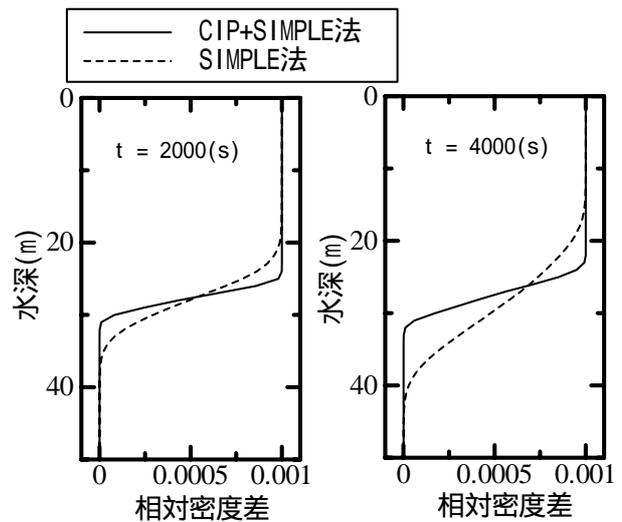
図-2 内部セイシュの計算結果における相対密度差の鉛直分布(水平距離の中央地点)
