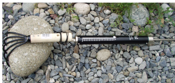
写真-1 河床固化の測定装置。ばねばかり（置針式丸型テンションゲージ、(株)大場計器製作所製）と熊手にて作成。径10 cm程度の礫には100 N程度の秤量が必要であること 13) から、秤量200 N（最小2 N）で瞬間最高値を計測可能な置針式を採用。
