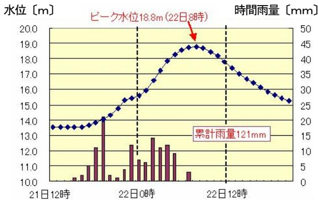
図-3 8月21～22日前線による大雨に伴う洪水における時間降雨量(美唄山)と美唄水位観測所水位の変動状況
