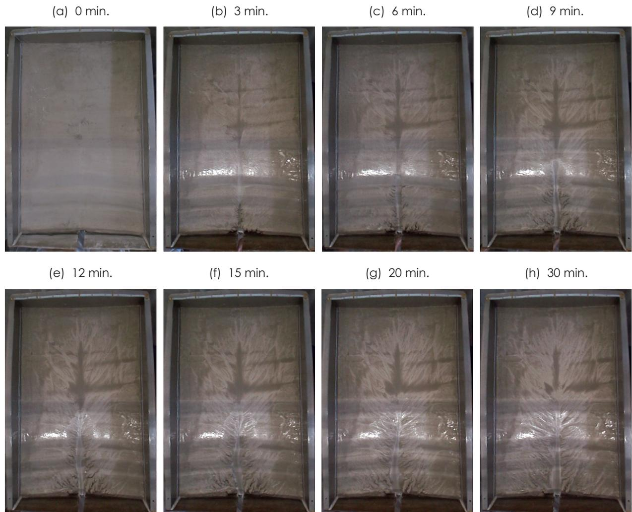
図-2 斜面の浸食過程 ( $R_{cc}=0.10$ )
