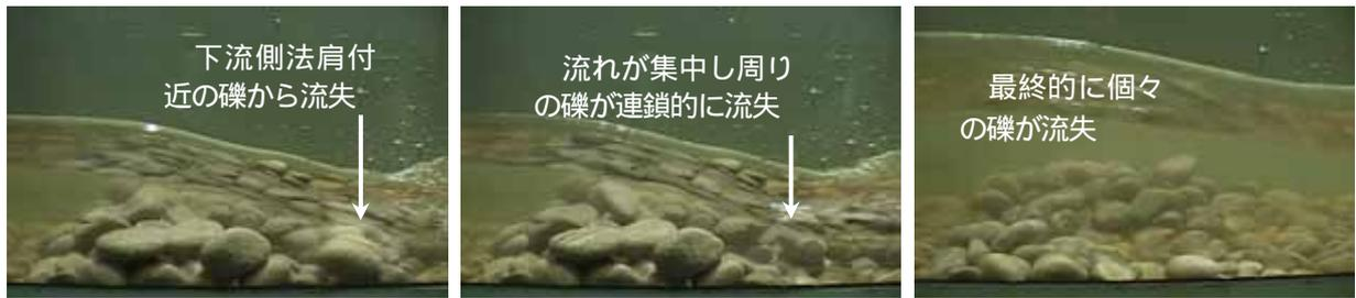
写真-3 礫ばら置きの場合の流失プロセス (case.1)
