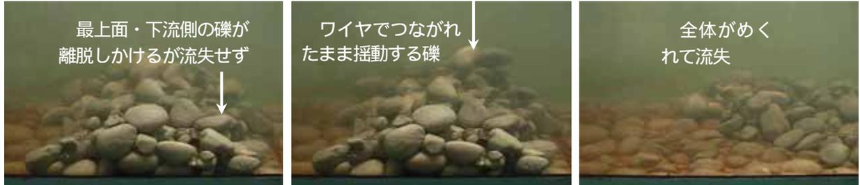
写真-4 連結礫の場合の流失プロセス (case.3)
