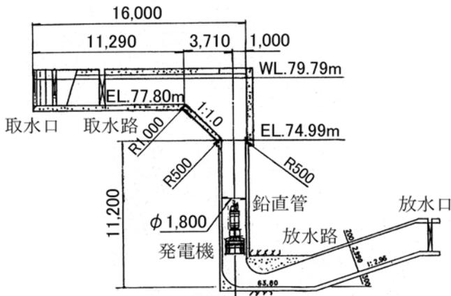
図-2 発電施設断面図
