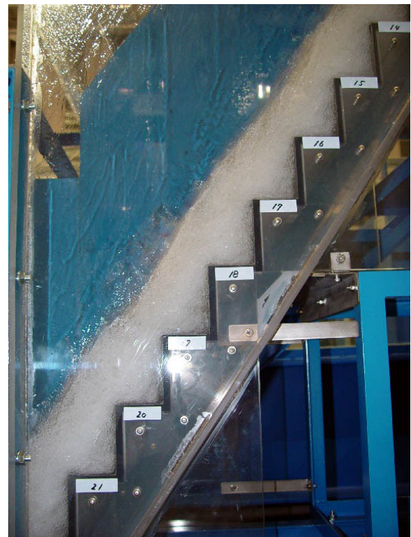
写真 - 1 階段状水路の Skimming flow
