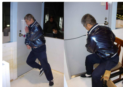
写真-5 ドア押し開け力測定概要
