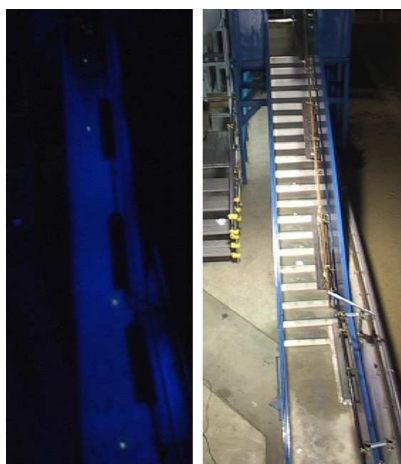
写真-1 可視化法による表面流速測定画像例（左：白点がトレーサ、右：階段）
