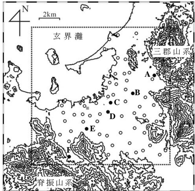
図-1 福岡都市圏の地形および測器設置点. ○と●は温度計と温湿度計の設置点, ■は福岡管区気象台, 点線は解析領域を示す.
