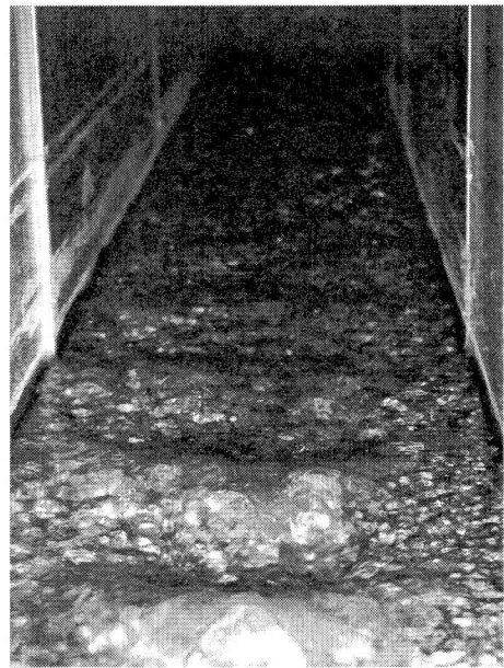
写真-1 礫を用いた移動床水路実験により形成された反砂堆（筑波大学宮本邦明教授より提供）
