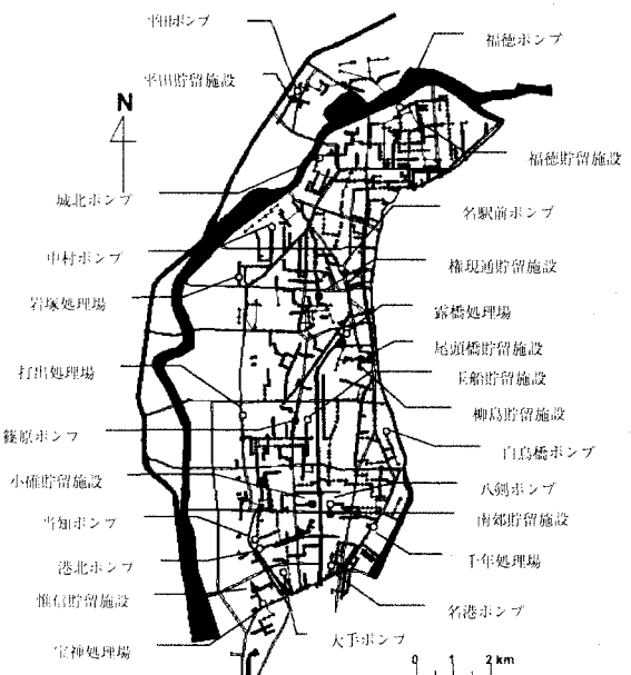
図6 マンホールと下水道の配置
