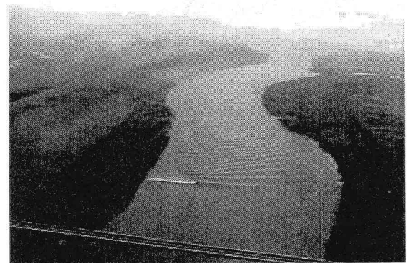
図-1 ソリトン分裂を伴い十勝川を遡上する津波 (陸上自衛隊撮影。2003 年 9 月 26 日 AM6:30 頃、十勝川河口橋付近。)
