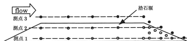
図-3 間隙水圧の測定ポイント
