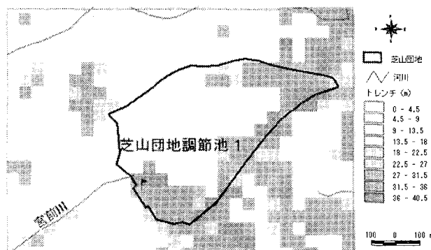
図-9 防災調節池流域における想定した浸透トレンチ長さの分布(単位:m)
