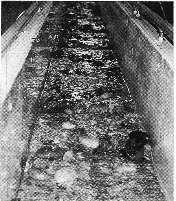
写真－1 階段状河床波（礫列）の形成状況
