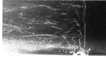
写真-1 側壁面極近傍の流況 ( B/H=5 , z=0.5\text{mm} , z^+=7.4 )
