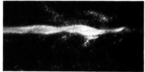
写真-2 界面の可視化（渦層の変形）
