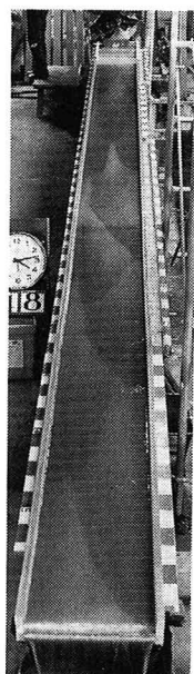
写真-4 大流量の場合の単断面化 流量 1000\text{cm}^3/\text{s} 以外は、写真-3と同じ
