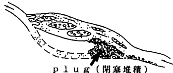
図-1分岐部の閉塞堆積例
