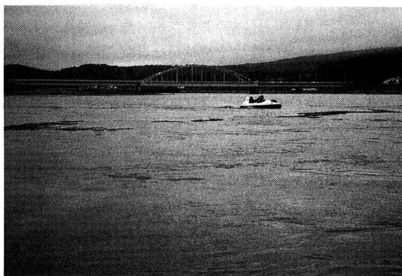
写真-5 尻別川、出水ピーク時のホバークラフトによる横断深淺測量，1990年4月23日 17:42
