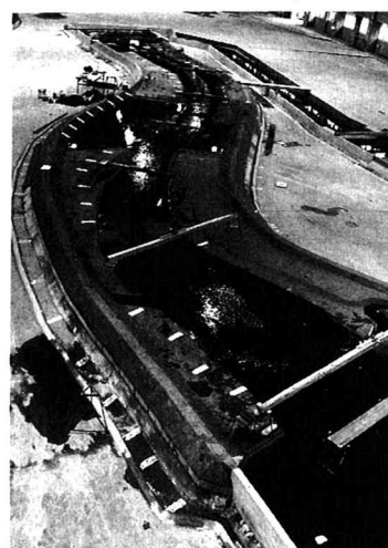
写真3 沼沼川河道模型 (縮尺1/20) 種々の水位となるよう通水を行い、現地の抵抗特性と比較を行う。
