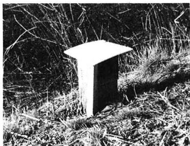
写真-1 距離標を利用した標定点
