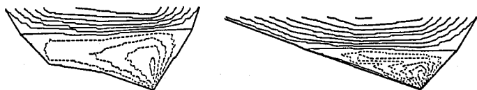
図-2 流速分布 (下げ潮時) 上流断面 下流断面
