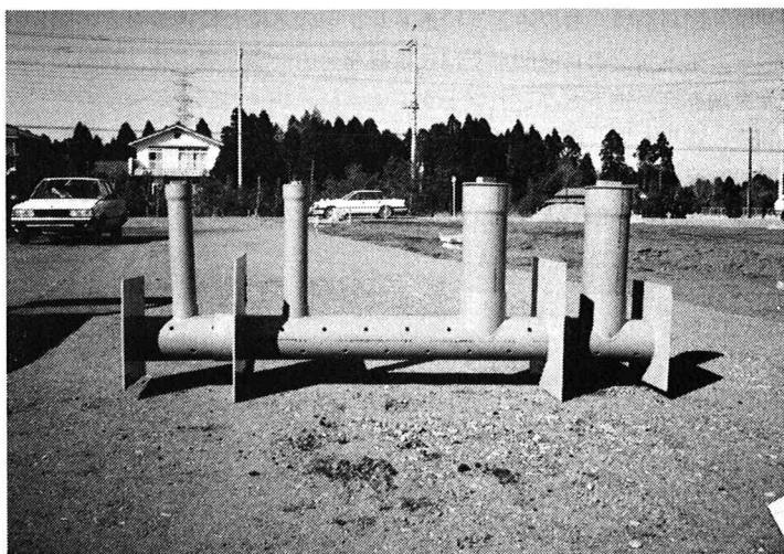
現地浸透能試験装置
