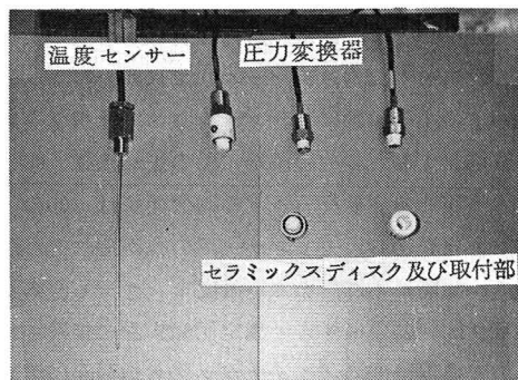
写真-3 温度センサーと圧力変換器およびその取付部
