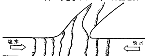
図-2(b) 分流部での流況 (平面図)
