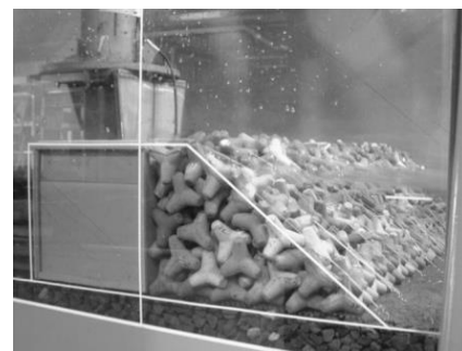
図-1 2 防波堤模型の設置状況
