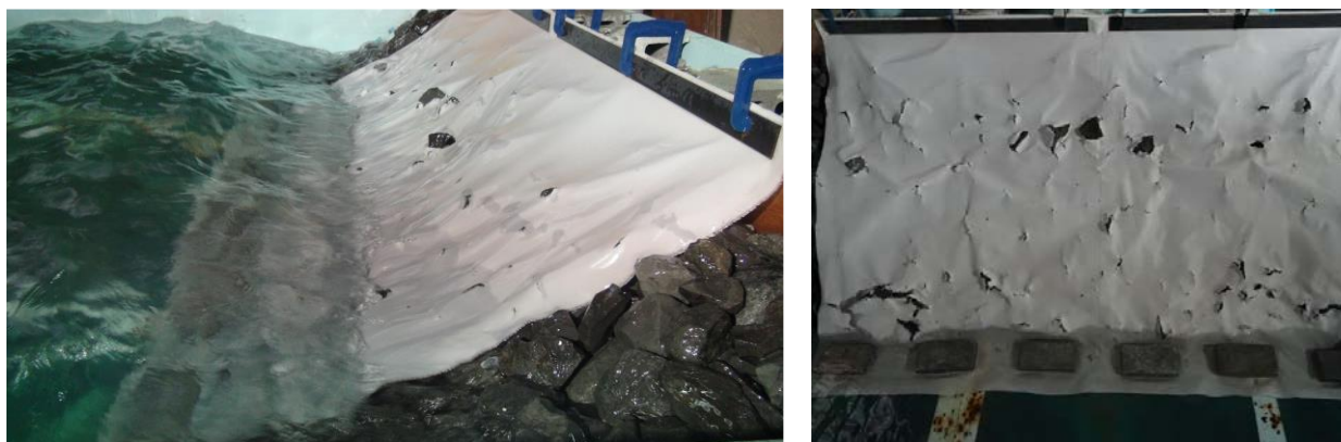
図-8.1 防砂シートのフラッタリングに対する耐久試験 28)
