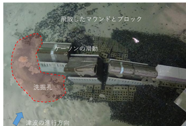
図-4.2 浦戸湾湾口防波堤の洗掘実験 18)
