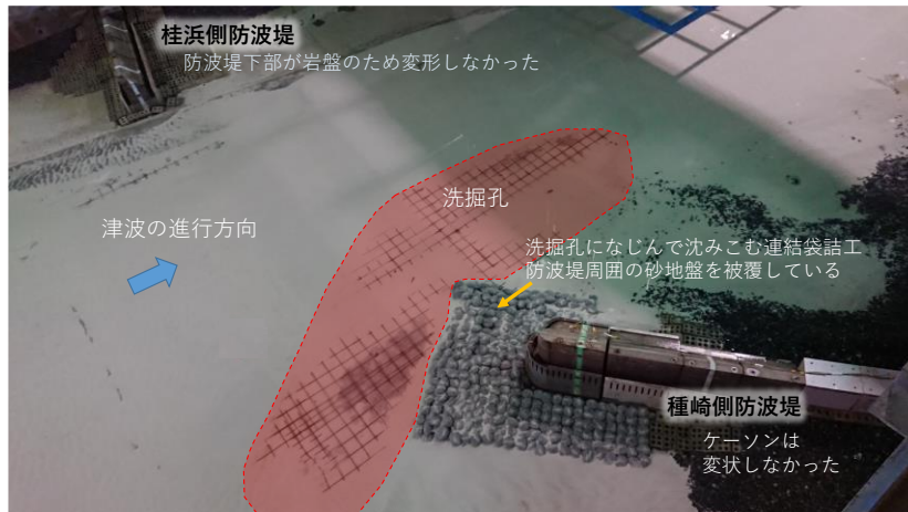
図-4.4 浦戸湾湾口防波堤の袋詰め被覆工を用いた対策実験
