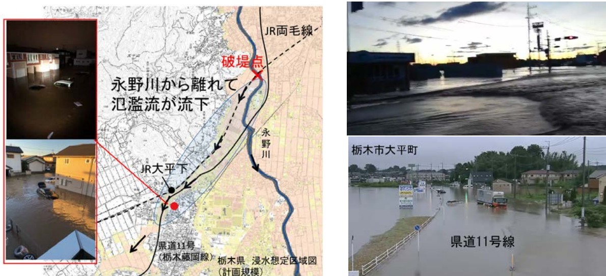
図27 永野川の破堤点からの氾濫流の流下（氾濫流は永野川の川筋から離れ、県道を流下する）
