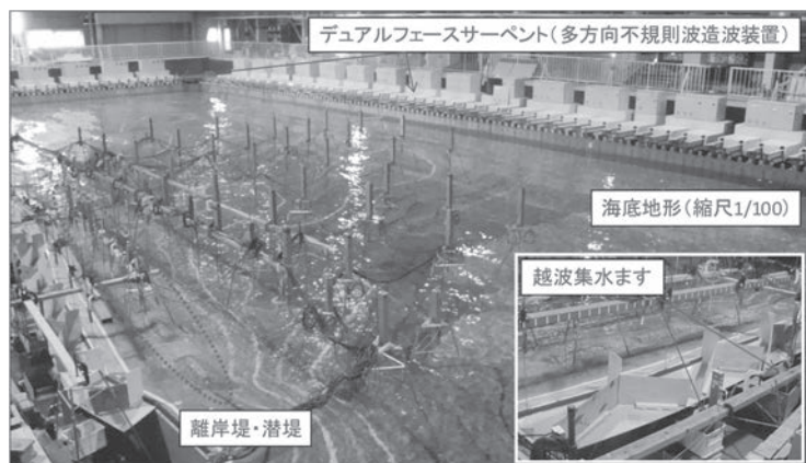
図-2.1 大型平面水槽と海底地形模型
