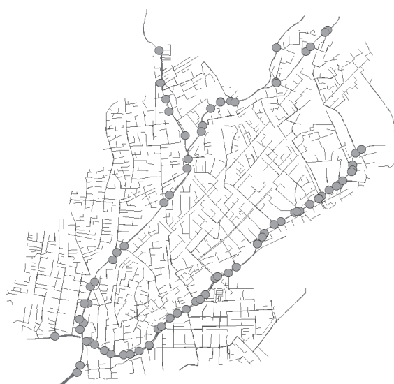
図-16 下水道管路と余水吐
